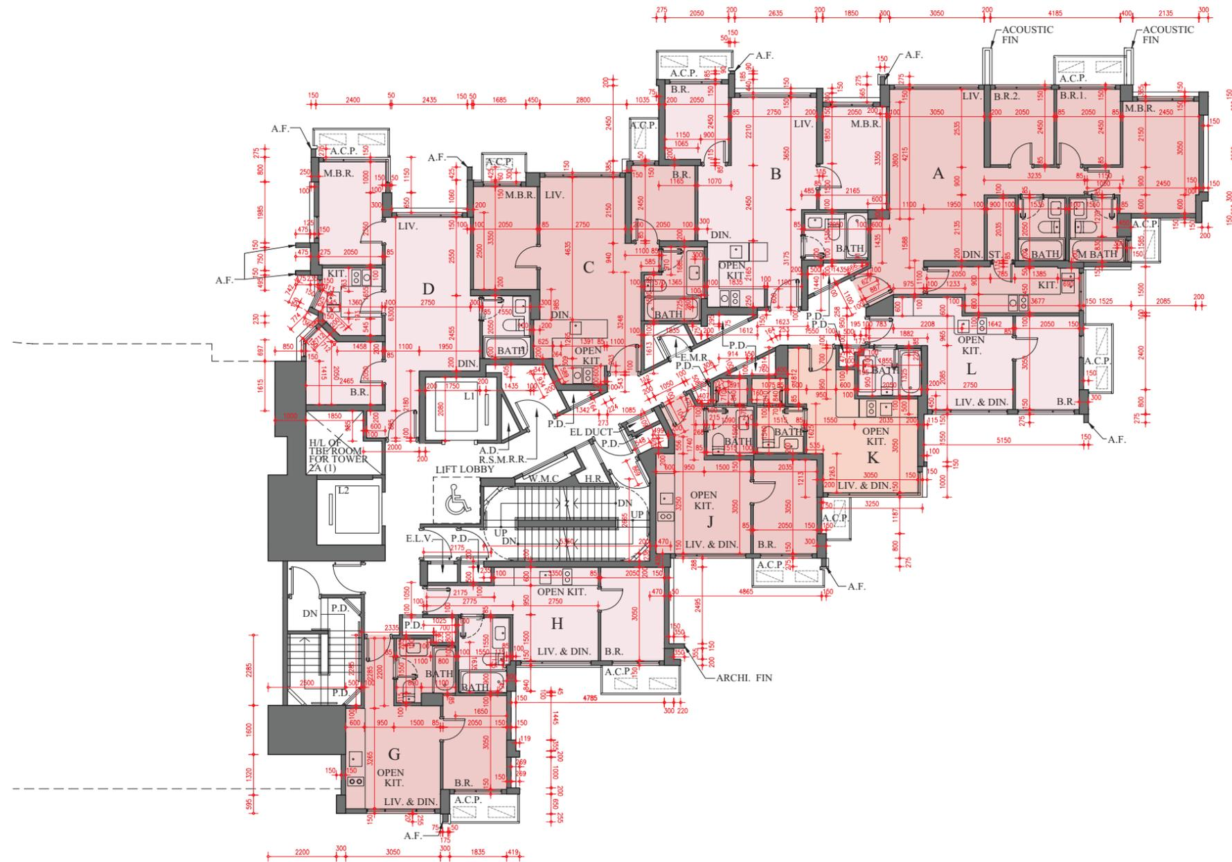
每個住宅物業的樓板（不包括灰泥）的厚度：A、B、C、G、H、J、K及L單位：125毫米及150毫米；D單位：125毫米、150毫米、200毫米及575毫米
